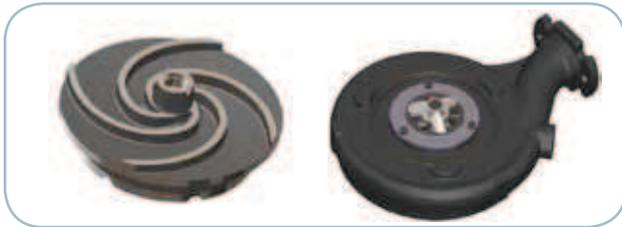
La girante GR, progettata per raggiungere alte prevalenze e alti rendimenti viene applicata a motori con potenza fino a 7,2 kW, trovando impiego in ambito zootecnico, alimentare, civile e ovunque sia necessario tritare il liquido pompato. Sul piatto di rasamento è realizzato il sistema antibloccaggio (ACS=Anti Clogging System), costituito da un solco che favorisce l'espulsione dei corpi tritati, garantendo l'inintasabilità della pompa e la pronta riportenza anche con basse potenze.
