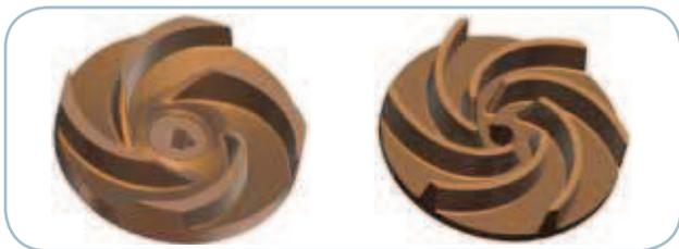
Le pompe **DRB** e **DGB** sono realizzate in bronzo B10 ed hanno girante multicanale aperta idonea per acque con presenza di corpi solidi (DRB) e vortex per acque cariche (DGB). Sono indicate in presenza di acque marine o liquidi salmastri, trovando impiego in settori come quello ittico e zootecnico.
