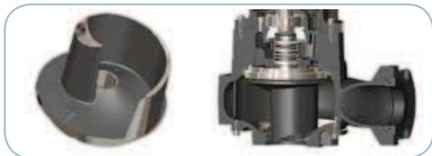
La particolare conformazione della pala della girante e del piatto di rasamento assicurano l'espulsione dei corpi offrendo loro una via di fuga.
