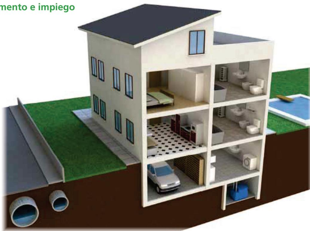
La vasca di raccolta riceve le acque reflue domestiche provenienti da scarichi di qualsiasi natura ed eventuali caditoie di acqua piovana o di infiltrazione.
