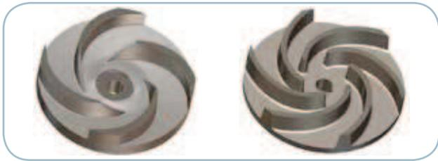
Le pompe **DRX**, **DRY** e **DGX** sono realizzate in acciaio INOX CF8-M (AISI 316) e hanno girante multicanale aperta idonea per acque con presenza di corpi solidi (DRX, DRY) e vortex per acque cariche (DGX). Sono indicate in presenza di liquidi corrosivi e aggressivi, quindi possono essere impiegate per impianti industriali nel campo chimico e farmaceutico oppure in presenza di acque marine.
