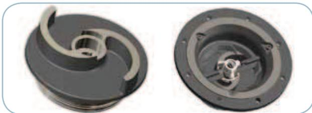
La speciale idraulica impiegata con motori da 2,2 a 3,0 kW 4 poli è realizzata da un sistema di triturazione che consiste in una robusta girante a "S" radente al piatto di rasamento con foro di aspirazione dentellato. Sia la girante che il piatto di rasamento sono in ghisa EN-GJS-600-3 trattati termicamente per un maggior indurimento superficiale. Tale sistema viene consigliato in ambito agricolo, zootecnico e civile, in presenza di liquidi particolarmente carichi di corpi estranei triturabili.
