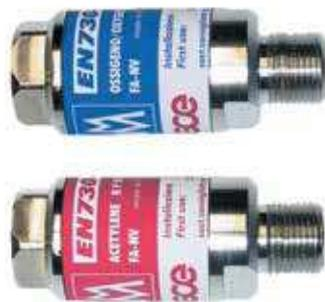
Le valvole di sicurezza MV93-RP sono prodotte da GCE secondo la norma EN730-1 e vanno applicate in uscita al riduttore di pressione (attacco 3/8"). Garantiscono la protezione totale contro i ritorni di fiamma (FA) e di gas (NV). Grazie alle ridotte dimensioni trovano facile alloggiamento in uscita a qualsiasi riduttore e garantiscono portata adeguata anche per operazioni di taglio fino a 300 mm.
