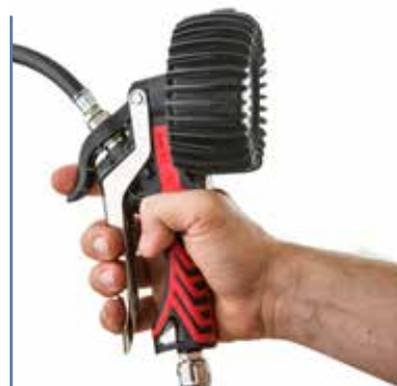
RILASCIARE ENTRAMBE LE LEVE PER CONTROLLARE LA PRESSIONE RELEASE BOTH LEVERS TO CHECK THE PRESSURE LIBERER LES DEUX GACHETTES POUR CONTROLER LA PRESSION BEIDE HEBEL ABLASSEN, UM DIE LUFTDRUCK ZU PRÜFEN
