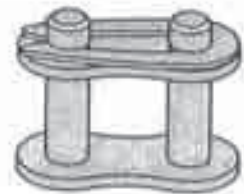
Giunto con molletta Connecting link with spring clip
