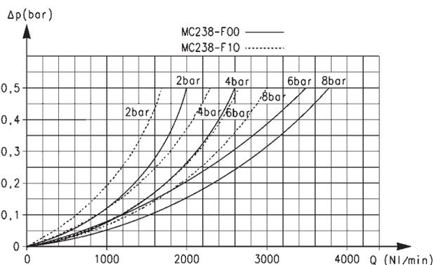
Diagramma di portata per i modelli: MC238-F00 e MC238-F10
