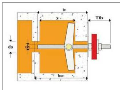
Materiale: Acciaio trattato con zincatura bianca  $\geq 5 \mu$  su tutti i componenti.
