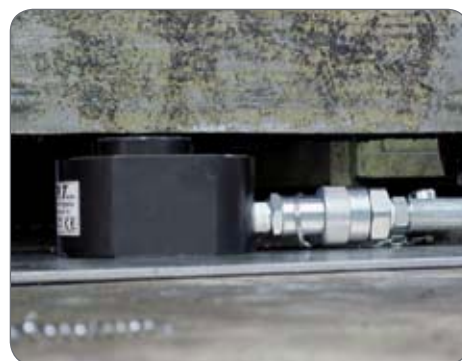
CRM 30/10XP utilizzati per l'allineamento di macchinari.
